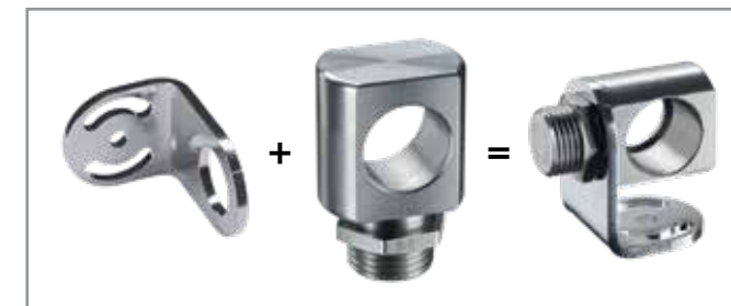
ACCTFB Asennusjalka M12x1 mittauspäille
