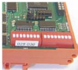
Osoitteet DIP-kytkimin (vanhat järjestelmät)
